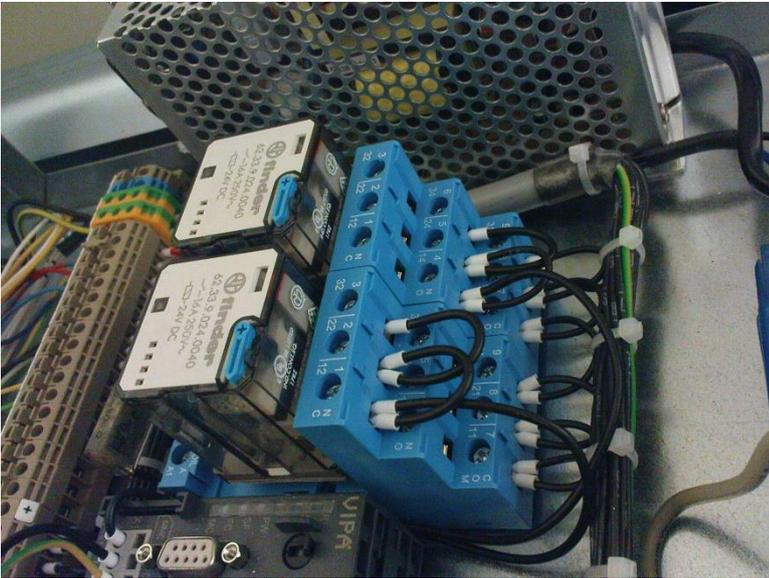
Bisher waren beide Hubmagnete auf den dazugehörigen Relais auf **normally closed** verdrahtet. Um die neue Funktion gewährleisten zu können, muss das Relais für den Eingangshubmagneten (der eben umgebaut wurde) umverdrahtet werden. Dazu bitte bei K1 (in dieser Abbildung der hintere) die Leitungen bei Klemme 1 abklemmen und bei Klemme 4 (**normally open**) wieder aufklemmen.
